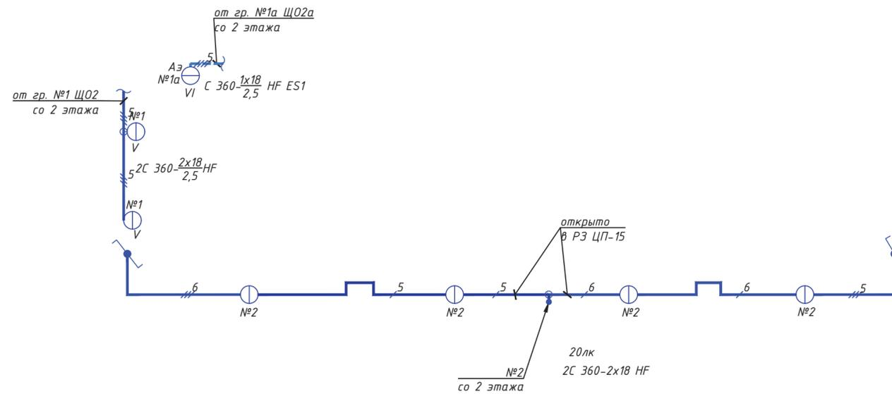
Схема электрическая принципиальная подключения N групп светильников эвакуационного освещения с автоматическим включением от прибора пожарной сигнализации
